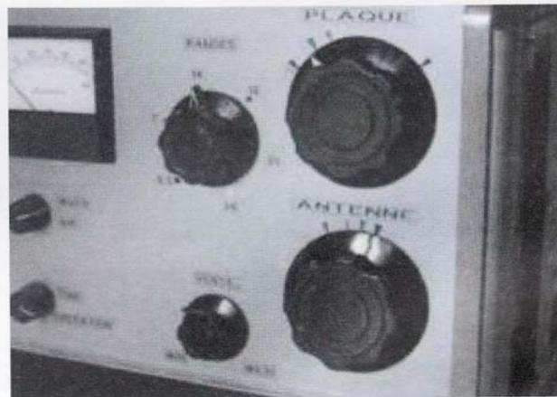
L'amplificateur a ensuite été testé sur toutes les bandes et il ne semblait plus y avoir d'amorçage entre les points de connexion du commutateur. Les repères de couleur ont été repositionnés correctement car ils ne correspondaient plus tout à fait avec les bons points de réglages.
