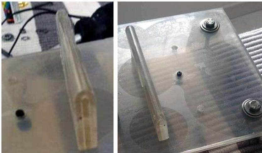
Détails de la barrette arrondie sur l'isolateur central : rôle important pour ne pas blesser le Twin-lead coté tirage.
